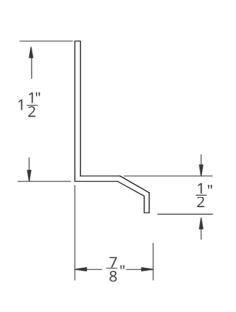
MATERIAL: ALUMINUM EXTRUSION 6063-T5 FINISH: POWDER COATED
